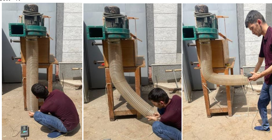
Рис. 4. Процесс гашения потери давления экспериментально
