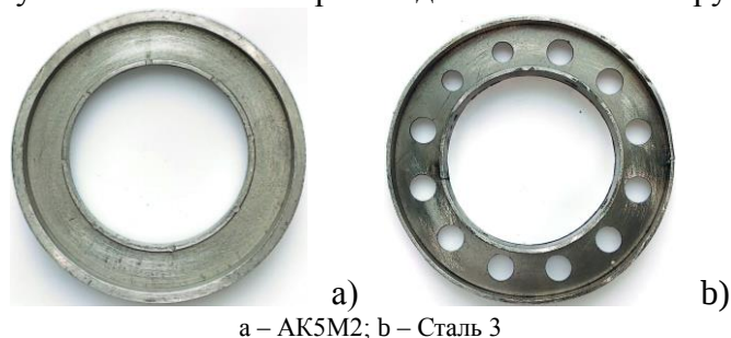
Рис. 1. Межпильные прокладки волоконотделительной машины
